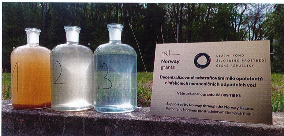
Obr. 6. Odběr vzorků vody v den předání technologie objednateli – 16. 4. 2024. 1 – přítok na biologický stupeň po mechanickém předčištění; 2 – odtok z dosazovací nádrže; 3 – vyčištěná odpadní voda po průchodu pilotní jednotkou pro odstraňování mikropolutantů.
