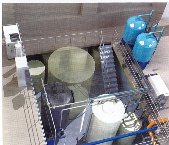
Obr. 3. 3D model instalace technologie čištění mikropolutantů
