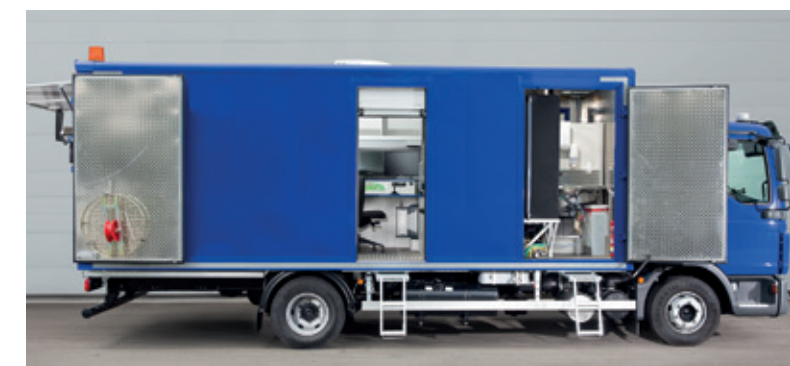
Vybavení kamerového vozidla vysokotlakým proplachovacím zařízením
