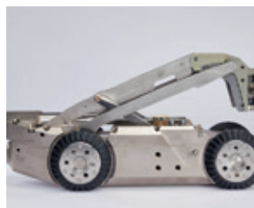
Elektrická zdvižná převodovka Plynulé polohování kamery od 150 mm
