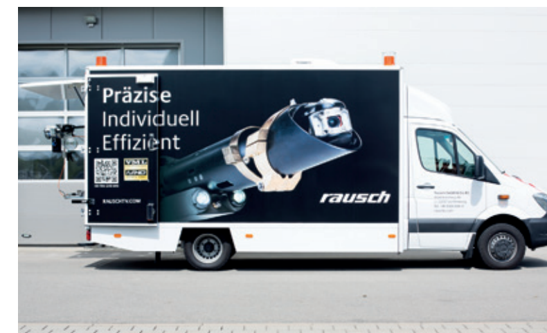
Vybavení vozidla Sprinter s kamerovým inspekčním systémem a kontrolním systémem tlaku skříňovou vestavbou kvůli větším prostorovým nárokům
