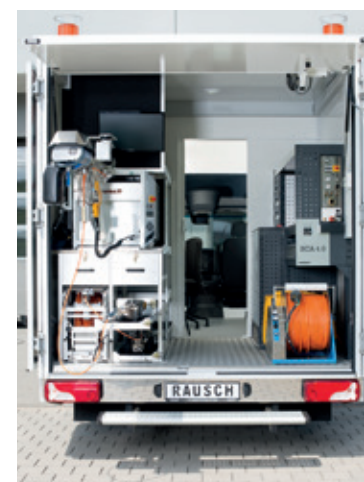
Vybavení vozidla Sprinter s kamerovým inspekčním systémem a kontrolním systémem tlaku skříňovou vestavbou kvůli větším prostorovým nárokům
