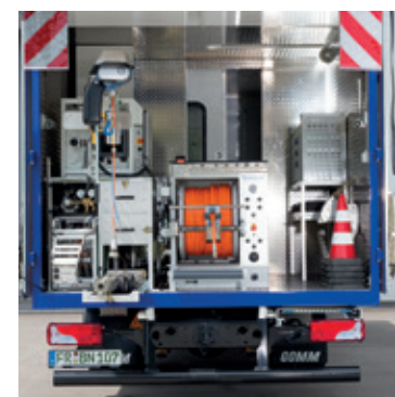
Vybavení kamerového vozidla vysokotlakým proplachovacím zařízením
